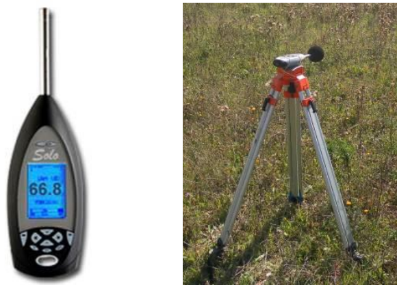
Figure 3 : Appareillage utilisé pour les mesures de bruit (Crédit photo : NCA, 2014)
